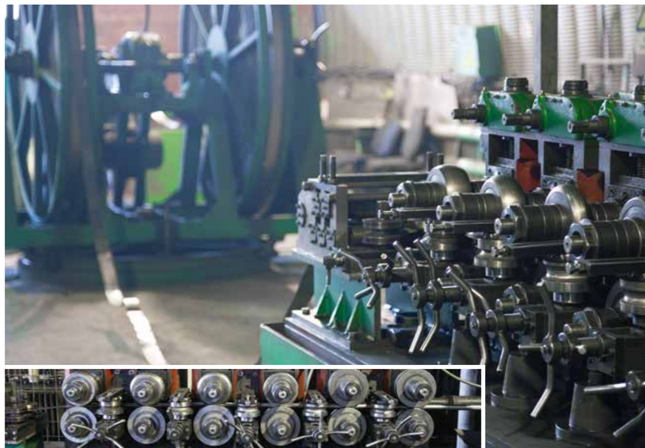
Трубопрокатный стан (линия производства сварного прямошовного металлического профиля)
