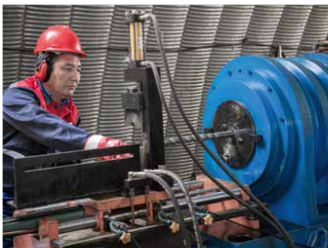
Станок для фигурной деформации тонкостенного металлического профиля
